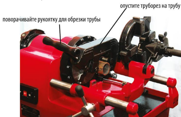
Рис. 7 Затягивайте труборез по \frac{1}{2} оборота за полный оборот трубы
